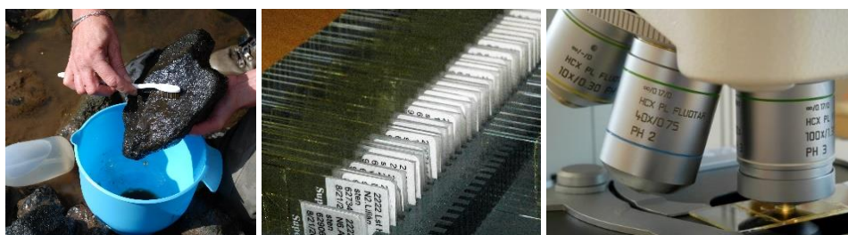
Figur 1. Provtagning av kiselalger görs i första hand från sten och innebär i korthet att minst fem stenar borstas av med en ren tandborste och påväxtmaterialet sköljs ner i en behållare. Stenarna insamlas längs en provtagningssträcka som är representativ för lokalen med avseende på bottensubstrat, vegetation, vattendjup, vattenhastighet och beskuggning. Kiselalgsskalen prepareras därefter fram på laboratorium och fixeras på objektglas. Kiselalgsanalys görs i ljusmikroskop i 1000 gångers förstoring med oljeimmersionsobjektiv. Mikroskopet ska helst vara utrustat med interferenskontrast, vilket gör att man kan se mycket små former tydligare än med andra tekniker.
