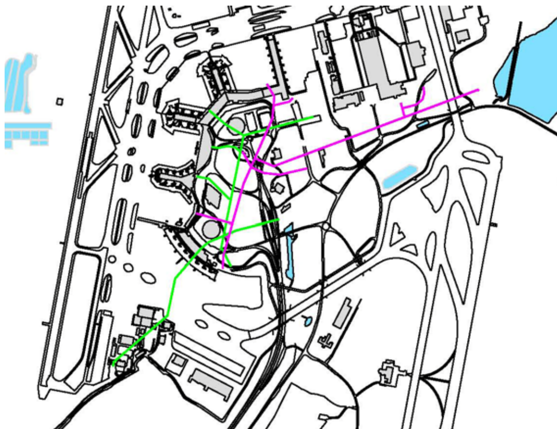
Figur 18 Arlandas försörjningstunnlar. Äldre delar är markerade i grönt och nya delar i lila.
