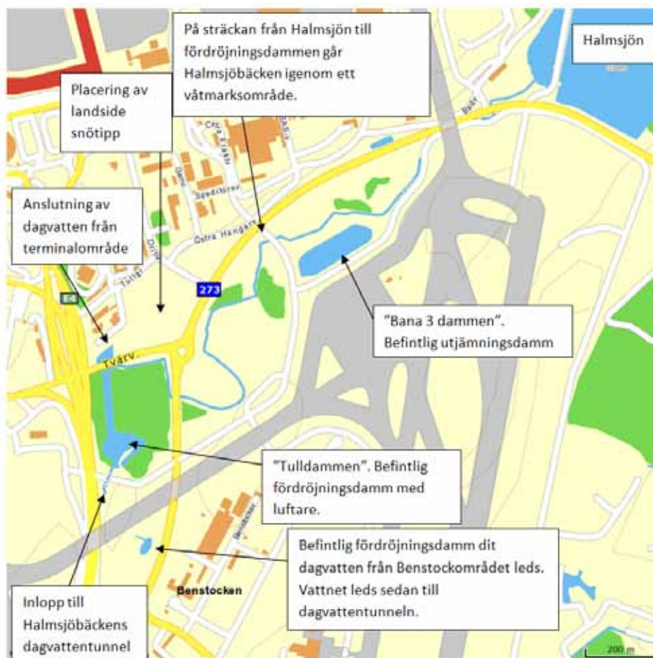
Figur 28: Nuvarande dagvattenhanteringen vid Halmsjöbäcken.
