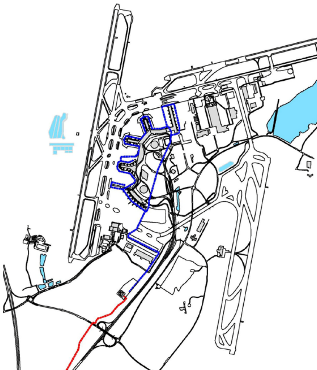
Figur 31 Flygplatsens hydrantledningssystem (blått). Den röda linjen är bränsleledningen från Brista.
