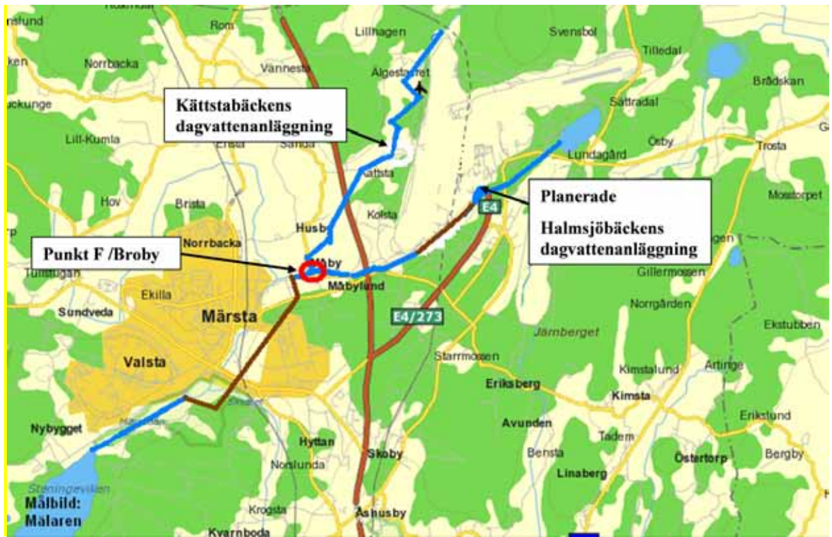
Figur 24: I figuren visas i blått de två delflöden som sammanförs i punkt F. De sträckor som är kulverterade är markerade i brunt. I punkt F/Broby startar Mårstaån som mynnar i Mälaren. Mårstaån är kulverterad under Mårsta samhälle.
