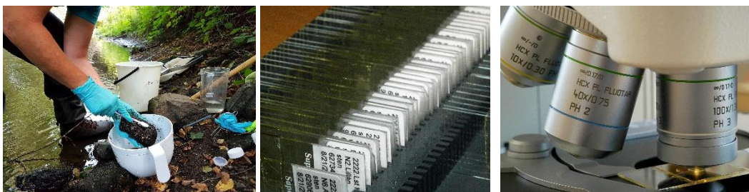
Figur 2. Provtagning av kiselalger görs i första hand genom att borsta av påväxt från stenar (t.v.). Kiselalgsskalen prepareras fram och fixeras på objektglas (mitten). Analys görs i ljusmikroskop i 1000 gångers förstoring med oljeimmersionsobjektiv (t.h.).
