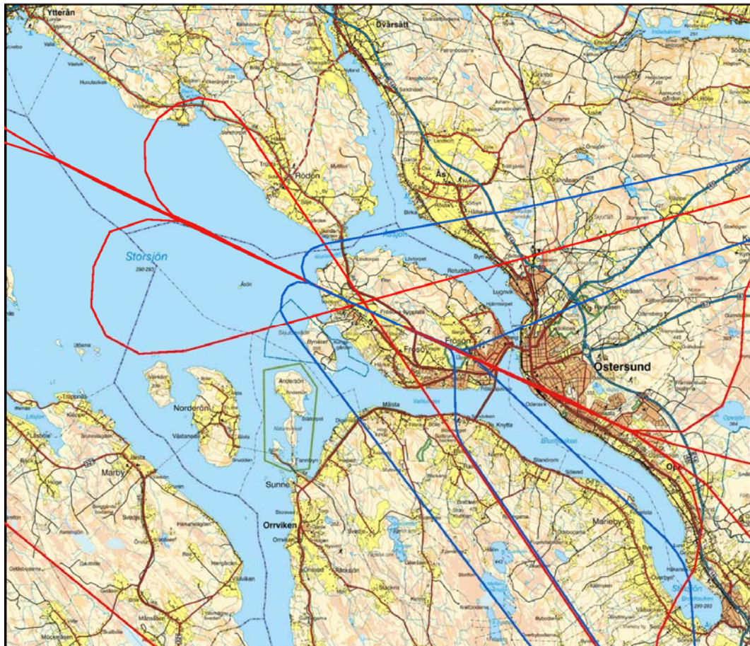
Figur 3 Huvudsakliga ruter i bullerberäkningarna för 2015 och 2025. Blåa ruter visar starter och röda landningar. Se stycke 3.3.
