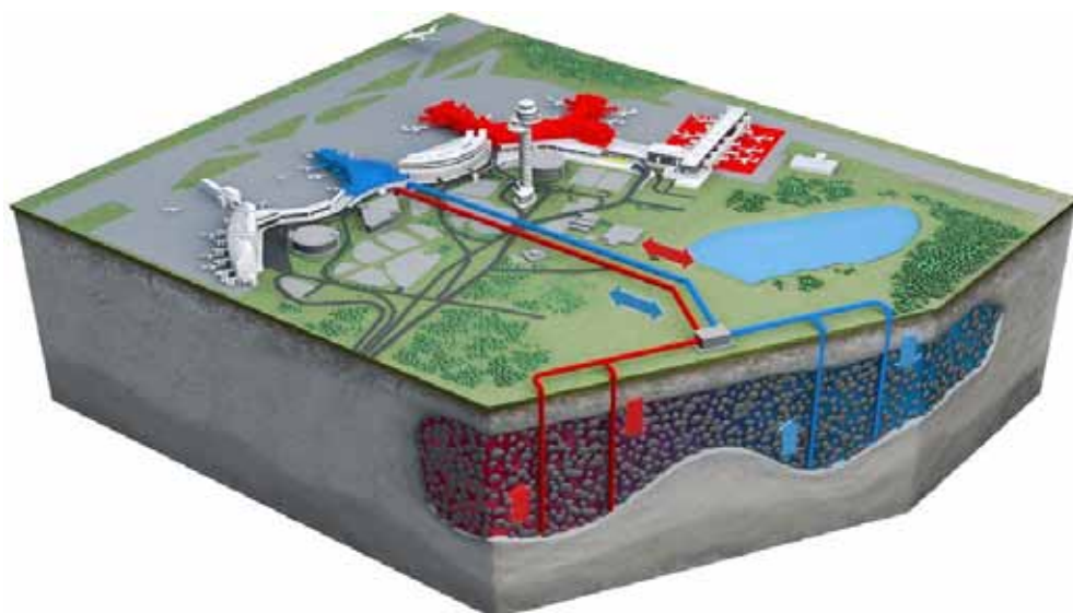
Figur 7.11. Princip för akvifärlagret
