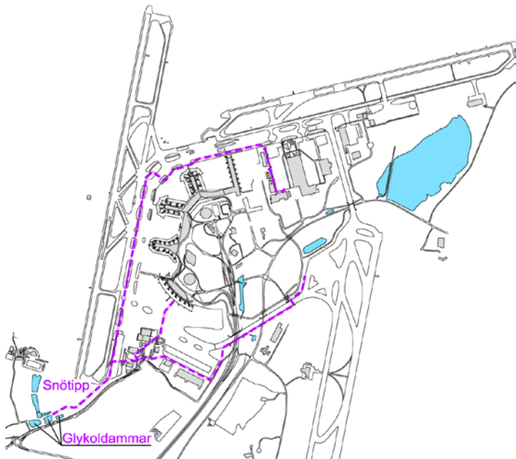
Figur 7.6. Glykolledningssystemet på Stockholm Arlanda Airport Från varje uppställningsplats leds B-glykol till dessa huvudledningar (stickledningarna till avisningsplatserna är inte på bilden).
