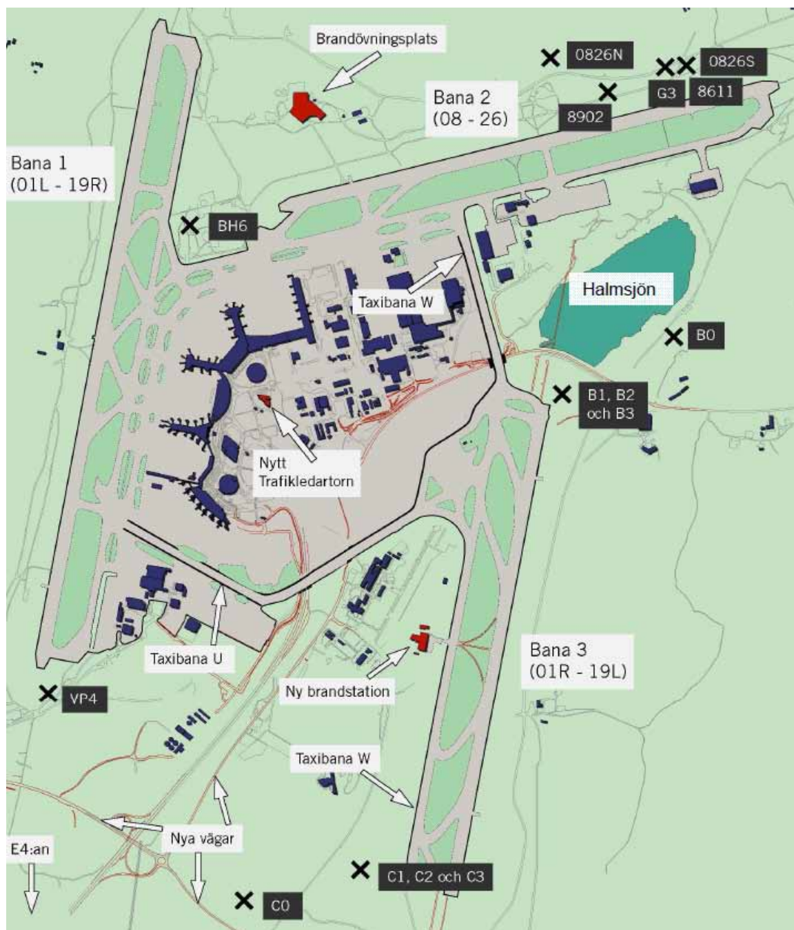
Figur 7.49. Provtagningsplatser för grundvatten (provpunkt G 3 har utgått). Grundvattnet kontrolleras i nuvarande program enligt följande:
