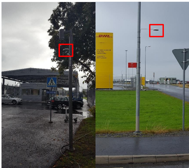
Figur 4. Mätning av kvävedioxid vid CVA väster om Rävelåsvägen (t.v.) och vid taximagasin/DHL (t.h.)
