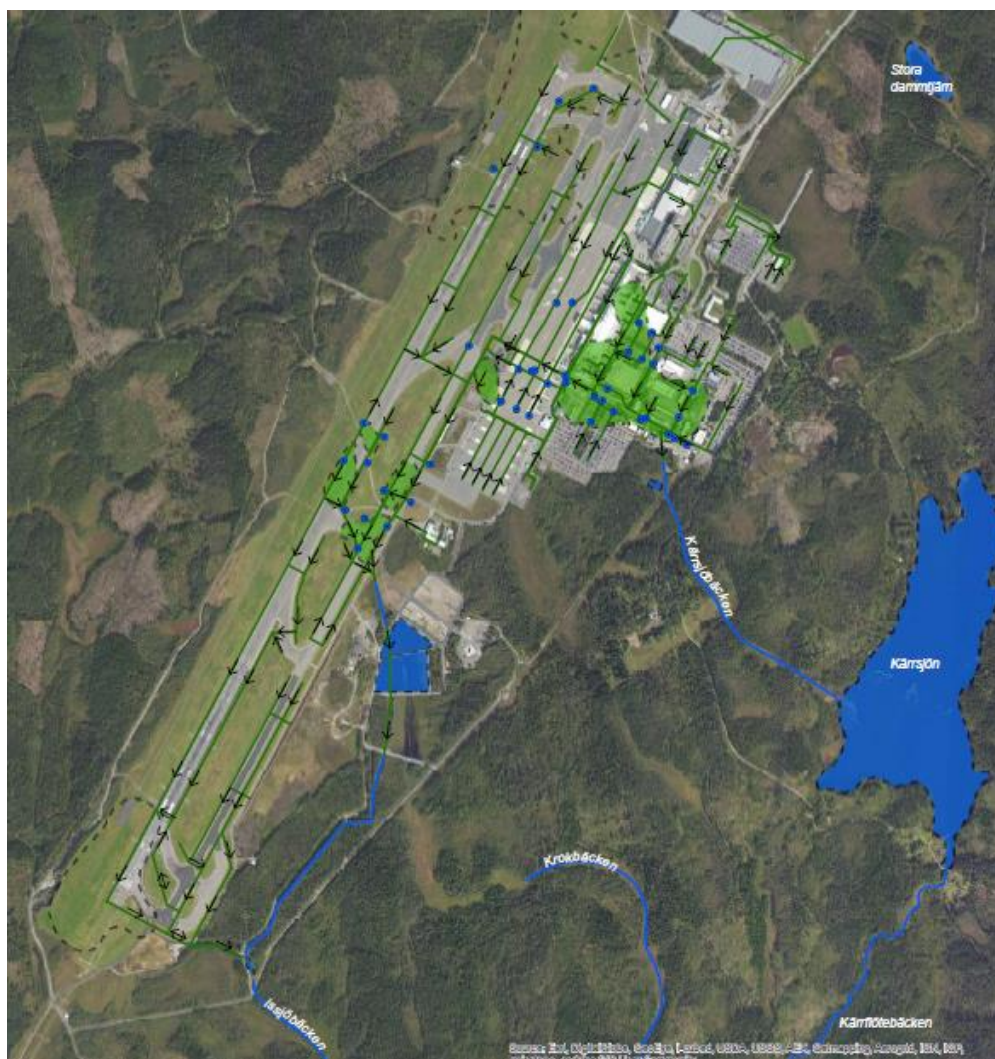
Figur 3. Karta med dagvattensystemet på Göteborg Landvetter Airport visar att huvuddelen av dagvattnet från de halkbekämpade landningsbanorna rinner till Issjöbäcken via en reningsdamm. Källa: Swedavia.
