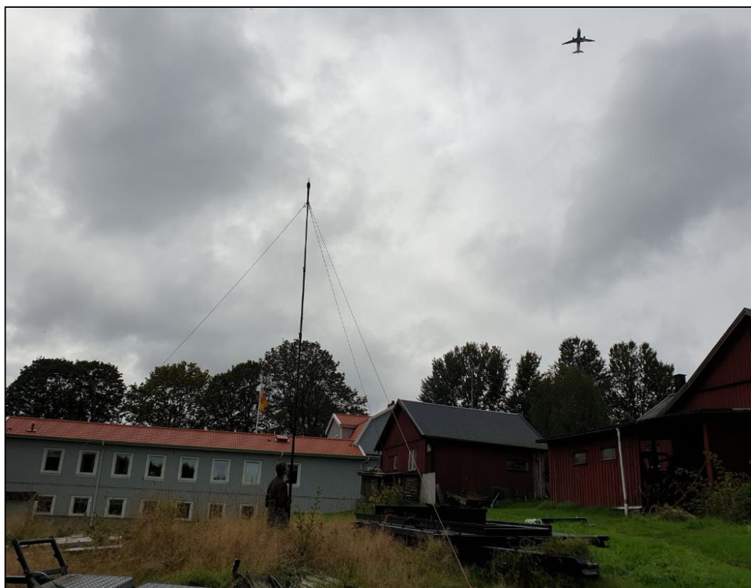
Figur 2. Bild på mätuppställningen i Prästgårde 1:6 tillsammans med exempel på en överflygning.
