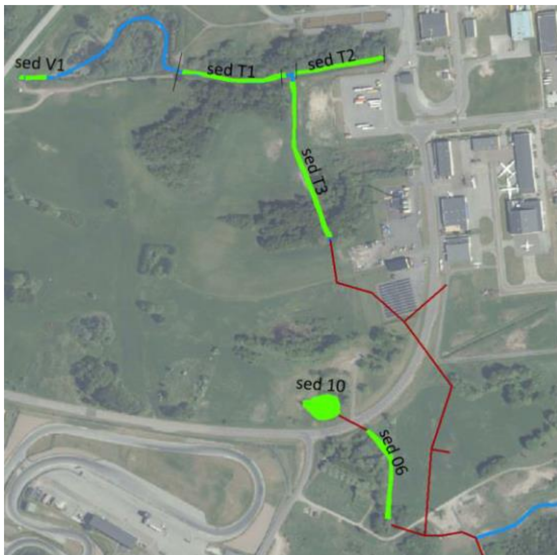
Figur 11. Provtagna delsträckor i diken norr om brandövningsplatsen. Gröna områden visar delar där prov uttagits i öppna diken. Vid V1 uttogs två prover, ett prov nedströms dammluckan och ett prov uppströms dammluckan. Bruna linjer är kulv (WSP, 2018d)erterade delsträckor och blå linjer är öppna diken som ej provtagits.
